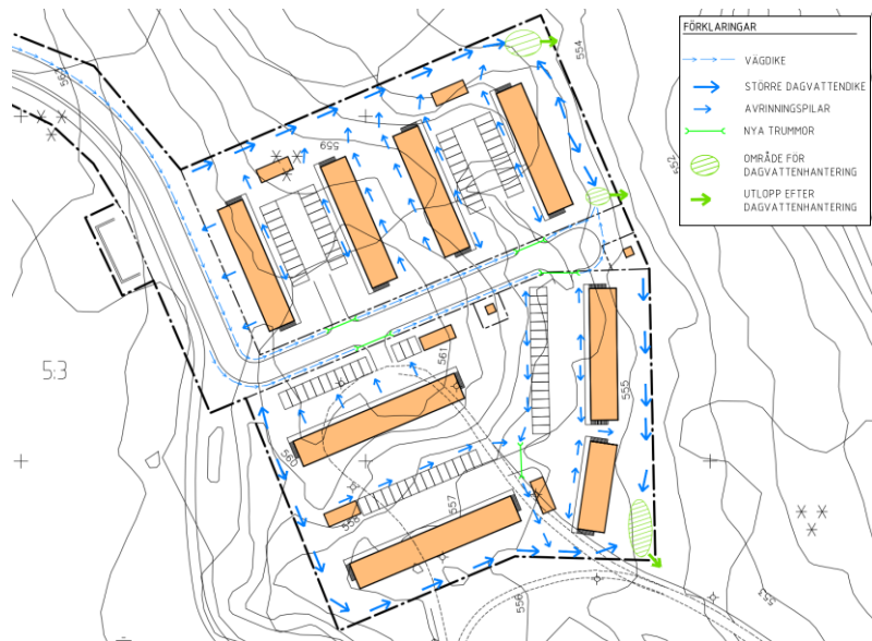
Förslag på avledning och rening av dagvatten.
